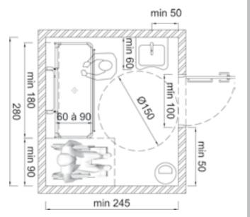
Salle d'hygiène disposant d'une aire de stationnement du fauteuil roulant afin de permettre l'assistance d'une personne aidante.
