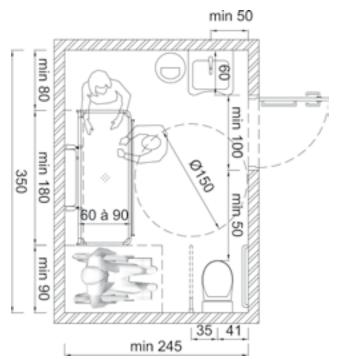
Salle d'hygiène disposant de toilettes, d'une aire de stationnement du fauteuil roulant et d'un second dégagement libre à l'extrémité de la table afin de permettre l'assistance d'une ou plusieurs personnes aidantes.
